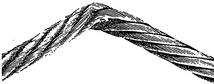
Bild 9. Drahtseil mit Knick
