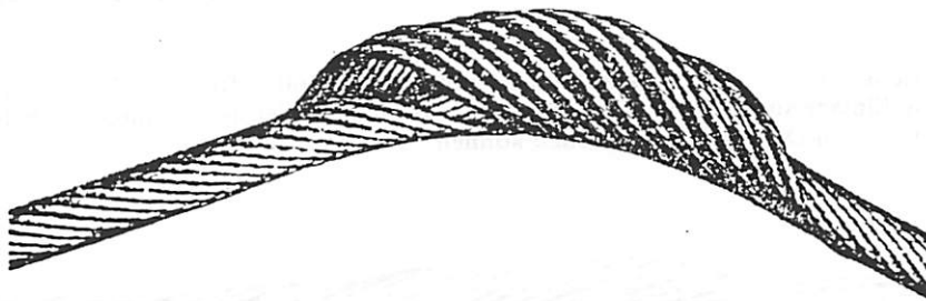
Bild 2. Drahtseil mit Korbbildung
