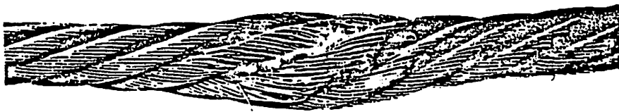
Bild 7. Drahtseil mit Abplatzung, entstanden durch Überfahren
