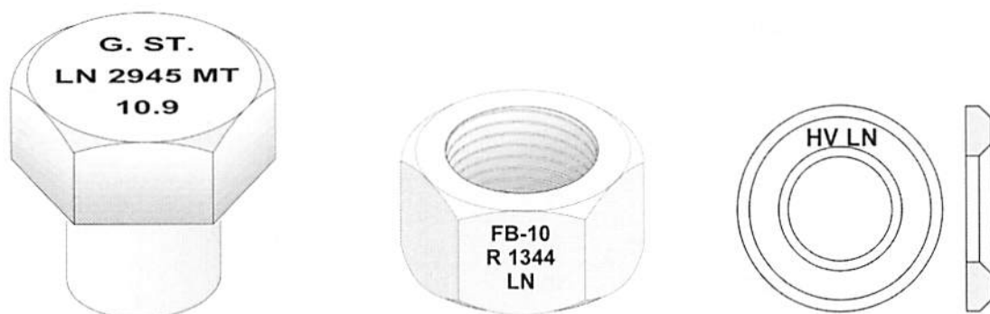
Fig. 58: HV-Schraubverbindung nach Liebherr-Norm mit Kennzeichnung „LN“
