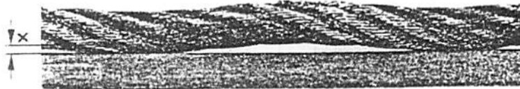
Bild 1. Drahtseil mit korkenzieherartiger Verformung
