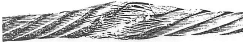
Bild 7. Drahtseil mit Abplattung, entstanden durch Überfahren
