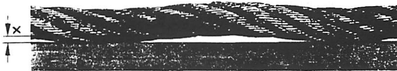
Bild 1. Drahtseil mit korkenzieherartiger Verformung
