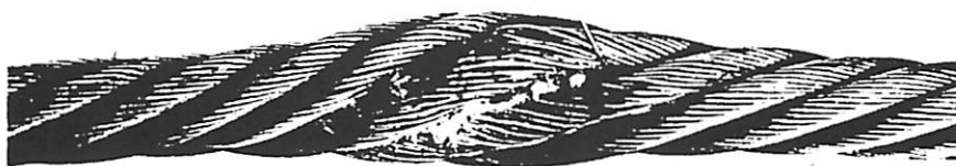
Bild 7. Drahtseil mit Abplattung, entstanden durch Überfahren
