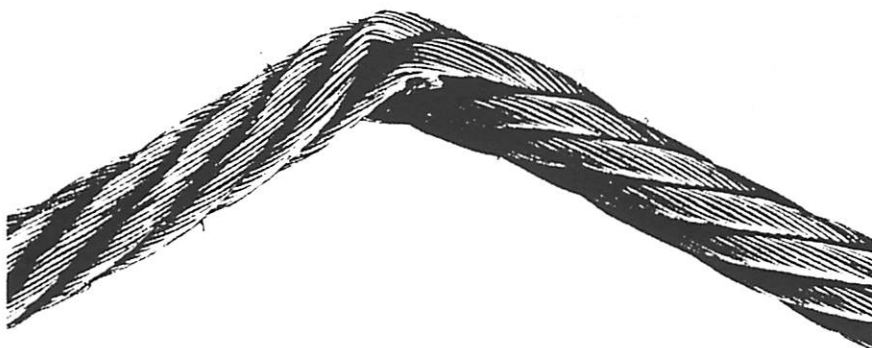
Bild 9. Drahtseil mit Knick
