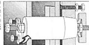
Bolzenverbindung Drehbühne Turm
