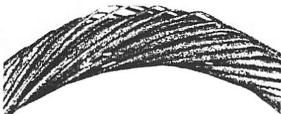
Bild 4 - Durch Korrosion und Abrieb stark gelockerte Litze
