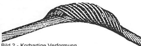
Bild 2 - Korbartige Verformung
