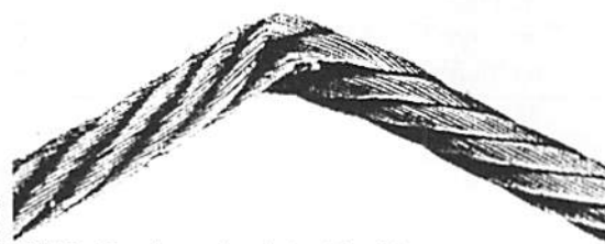
Bild 8 - Durch mechanische Einwirkung entstandener Knick
