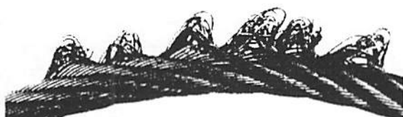
Bild 3 - Schlaufenbildung an einem Drahtseil
