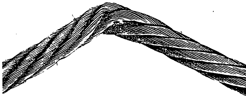
Bild 9. Drahtseil mit Knick
