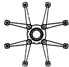
„Alle Euro Krane“ werden mit Hydraulikabstützung 600 mm Hub ausgeliefert. Jedes herkömmliche Kranfahrwerk und jeder geeignete Tieflader sind zum Straßentransport geeignet.
